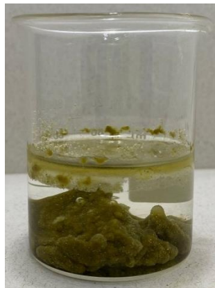
Okralin aglutinado com o óleo no fundo do béquer, após a mistura de fases.
